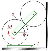
Оси цилиндров соединены спарником. Верхний цилиндр катится без проскальзывания по вертикальной плоскости. Нижний цилиндр находится в зацеплении с верхним и катится по пластинке массой  $m_1$ , скользящей по горизонтальной плоскости. Радиусы цилиндров  $r$ . Масса нижнего цилиндра  $m_2$ . К нижнему цилиндру приложен момент  $M$ . Составить уравнение движения системы. За обобщенную координату принять угол поворота спарника  $\varphi$ .
